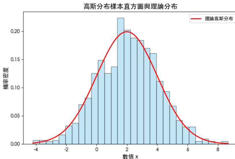
此圖顯示從真實常態分佈抽樣的結果與理論分佈的比較，藍色直方圖代表從  $N(2, 2)$  抽出的 1000 筆樣本所形成的分佈，紅色曲線則為理論上的常態分佈密度函數，從圖中可以觀察到，實際樣本分佈大致貼近理論分佈，說明了隨機抽樣可以合理反映母體分佈形態。
