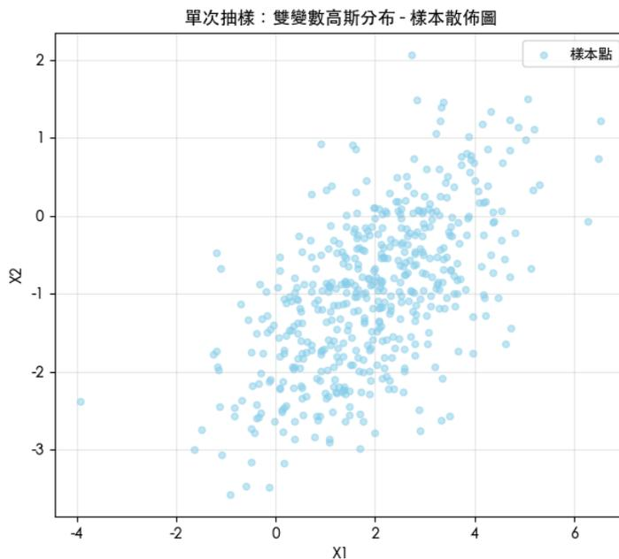
此圖顯示從設定的雙變數高斯分佈 ( $\rho = 0.6$ 、 $\mu = [2, -1]$ ) 中抽取 500 筆樣本所形成的散佈圖，樣本點大致集中在  $[2, -1]$  附近，並呈現右上至左下斜向橢圓形分佈，反映變數之間具有正相關，這與我們設定的協方差矩陣一致，說明抽樣結果符合期望的統計特性。
