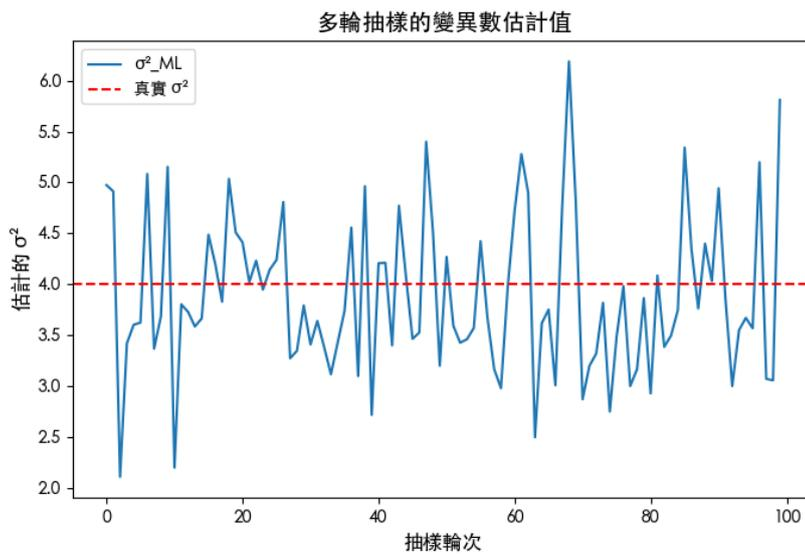
此圖顯示每輪抽樣後所得到的變異數估計值變化情形，與平均數相比，變異數的估計值波動稍大，且普遍低於真實值  $\sigma^2 = 4$ ，這反映出最大概似估計在有限的樣本
