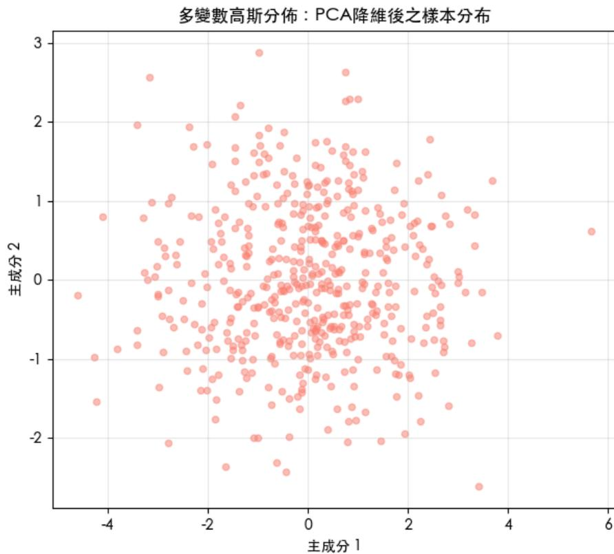
此圖利用主成分分析將原始三維資料降維至二維，並以散佈圖呈現樣本在主要變異方向上的分布情形，圖中可以看出，樣本點主要分佈在橢圓形範圍內，且集中於第一主成分方向上，顯示多數變異來自某一主軸，符合高斯分佈集中趨勢特性，此圖有助於從低維角度觀察高維資料的整體分佈結構與變異來源，並進一步佐證主成分分析能有效保留原始資料的重要資訊。
