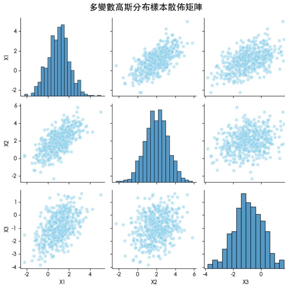
這張圖使用散佈矩陣呈現三個變數之間的兩兩關係與各自的分布情形，對角線上顯示的是每個變數的單變量分佈，皆近似鐘型，符合常態分佈特性；非對角線部分則為變數之間的散佈圖，呈現橢圓形分佈，顯示變數間的線性相關程度，從圖中可以清楚觀察到變數 X1 與 X2 呈現高度正相關，X1 與 X3 亦有中度正相關，這與協方差矩陣中所設定的正相關結構（像是 X1 與 X2 的共變異為 0.8）一致，驗證了樣本與母體分佈的高度一致性。
